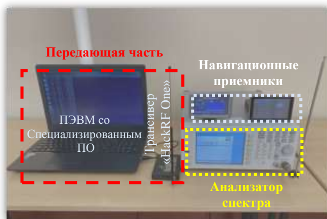
Рис. 1. ПАК для исследования спуфинг воздействий на навигационные приемники с использованием SDR-трансивера
